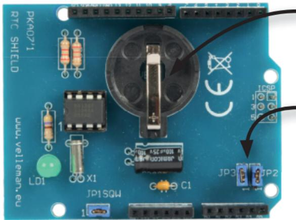
**Batería de repuesto:** alimenta el shield si la Arduino Uno no está activada.
