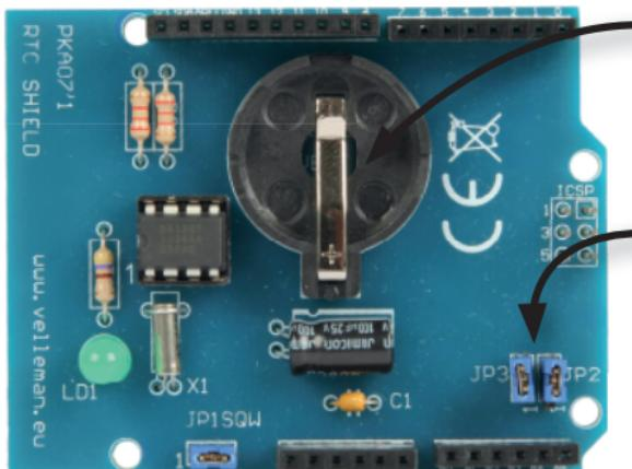
**Back-upbatterij:** voorziet het shield van spanning als de Arduino Uno niet actief is.
