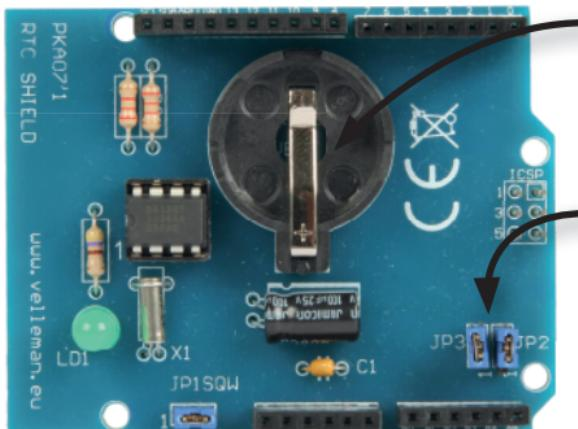
Le circuit intégré pilote une LED clignotant à la même fréquence que la sortie SQW. Via le cavalier JP1, on peut choisir si le signal va également jusqu'à la broche A3 du shield.
