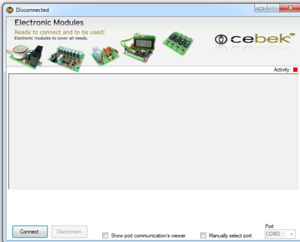
**Connect:** Conectar el sistema de comunicación simultánea entre el ordenador y la placa reguladora.
